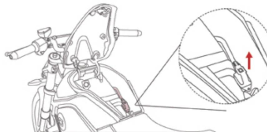
**3** Insérez la clé dans le verrou antivol de la batterie et tournez-le vers la droite. Retirez la batterie de la moto.
