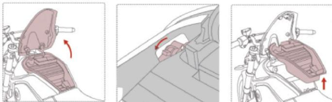
**3** Insérez la clé dans le verrou antivol de la batterie et tournez-le vers la droite. Retirez la batterie de la moto.
